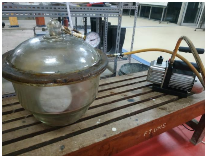
Gambar 1. Pengujian vacuum beton
