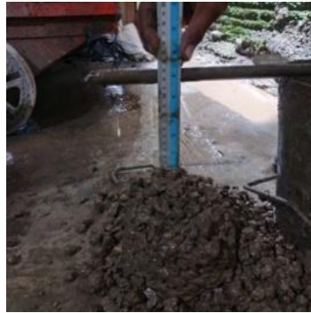
Gambar 2. Hasil Pengukuran Slump
