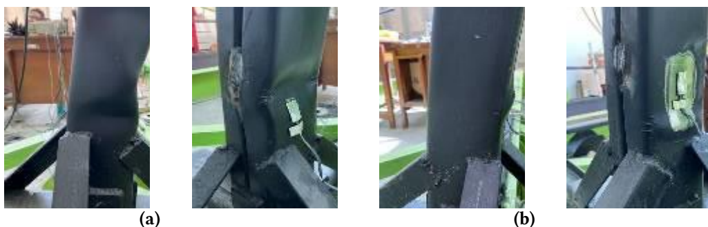
Gambar 21. Pola Kerusakan Tekuk pada Kolom: (a) Benda Uji Sambungan Tengah Tanpa Isi, (b) Benda Uji Sambungan Tengah dengan Isi
