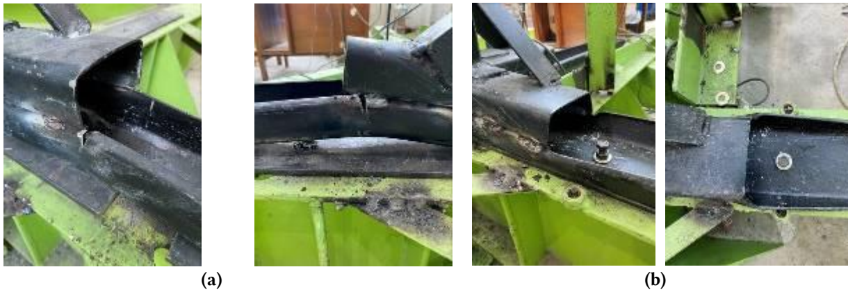
Gambar 22. Pola Kerusakan Fraktur pada Sloof: (a) Benda Uji Sambungan Tepi Tanpa Isi (b) Benda Uji Sambungan Tepi dengan Isi
