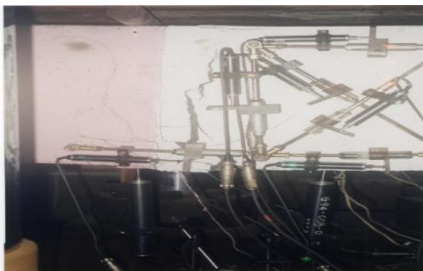
Gambar 7. Penempatan tranducer dan gambar retak
