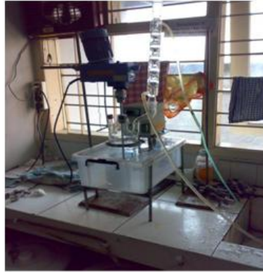
Gambar 1 Ekstraksi Biji Kemiri Secara Batch
