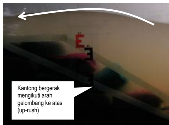
Gambar 4. Fenomena Up-Rush Sebagai Penyebab Terlepasnya Kantong Pasir dari Susunannya
