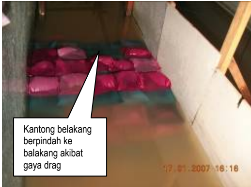
Gambar 5. Pergerakan Kantong Pasir pada Zona Puncak Susunan
