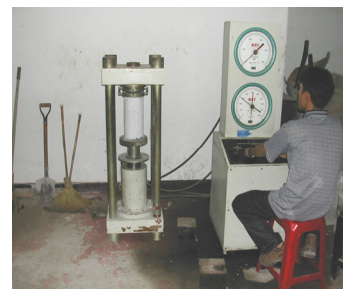
Gambar 1. Pengujian kuat tekan beton
