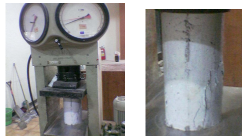
Gambar 1. Pengujian kuat tekan beton
