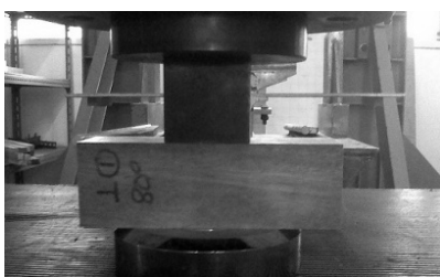
Gambar 7. penguji tekan dengan benda uji kayu Keruing dengan sudut serat kayu sebesar 80^\circ .
