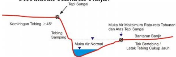
Gambar 11. Tipikal tepi sungai pada tampang sungai berbatasan langsung dengan tebing curam pada satu sisi dan terdapat bantaran banjir di sisi yang lain
