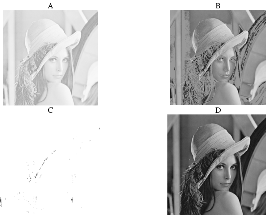
Gambar 10. Citra A hasil dari proses log transforms , citra B bentukan dari proses intensity sliced , citra C merupakan hasil dari proses histogram equalized , dan citra D merupakan bentuk dari power law transforms
