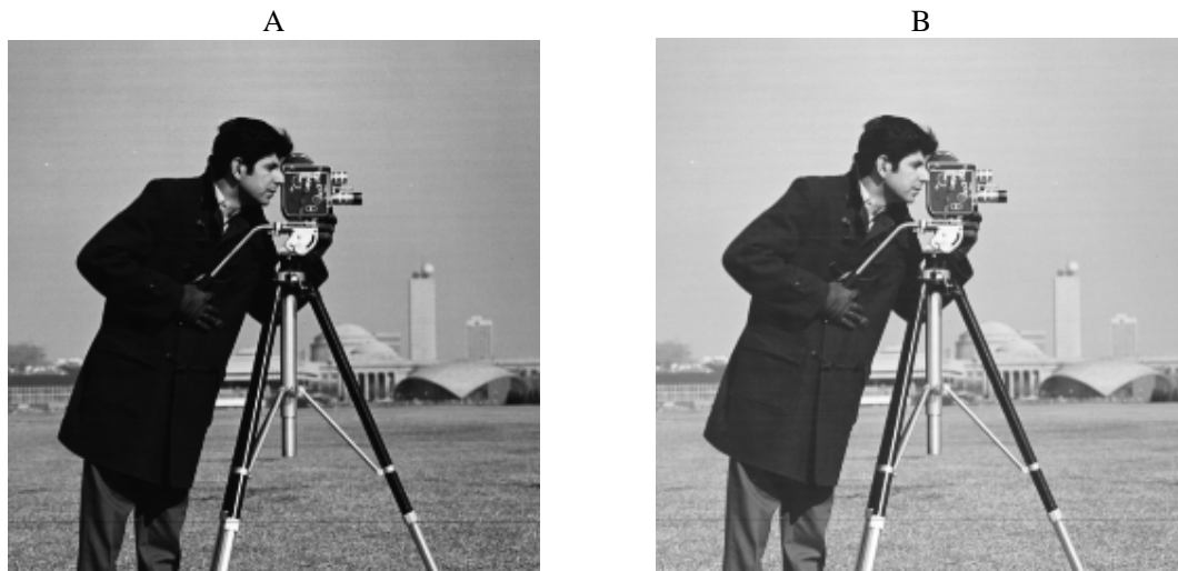
Gambar 6. Citra A adalah citra asli dan Citra B didapatkan setelah adanya proses transformasi power law dengan nilai \gamma 0.53
