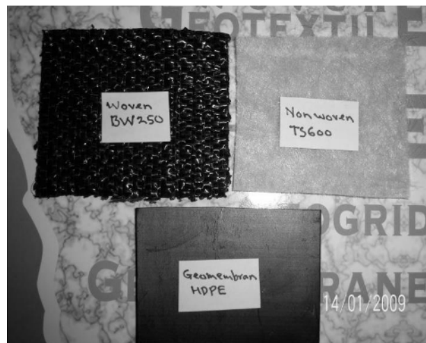
Gambar 1. Bentuk geotekstil tipe woven , non woven dan geomembran HPDE.
