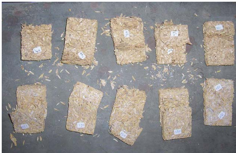
Gambar 46. Penampang patahan hasil pengujian geser core SP:UF
