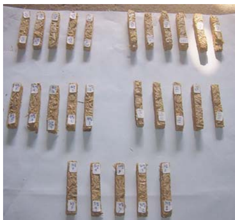
Gambar 47. Spesimen sampel uji impak core SP:UF
