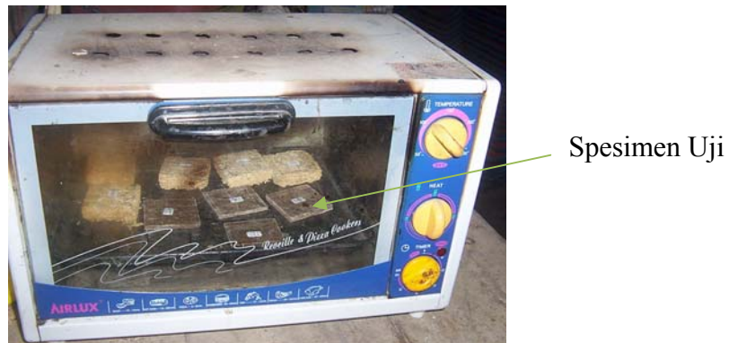
Gambar 35. Spesimen sampel uji kestabilan komposit skin
