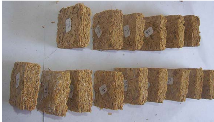
Gambar 53. Spesimen sampel uji densitas core SP:UF
