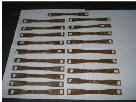
Gambar 28. Spesimen sampel uji tarik komposit skin berpenguat serat ramie
