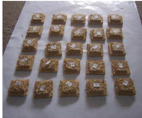
Gambar 44. Spesimen sampel uji geser core SP:UF
