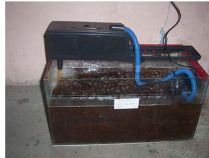
Proses perlakuan alkali serat ramie
