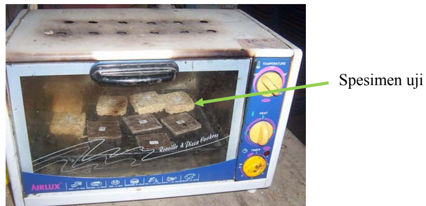
Gambar 55. Spesimen sampel uji kestabilan dimensi core SP:UF
