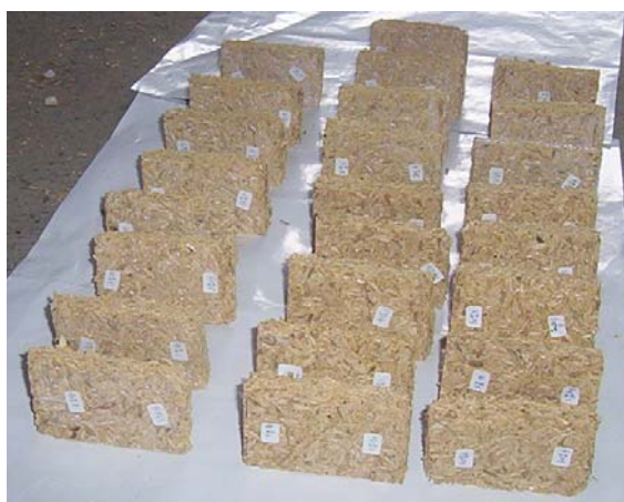
Gambar 50. Spesimen sampel uji tekan core SP:UF
