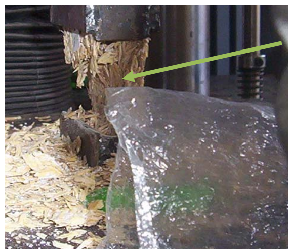
Gambar 52. Core hancur saat pengujian tekan
