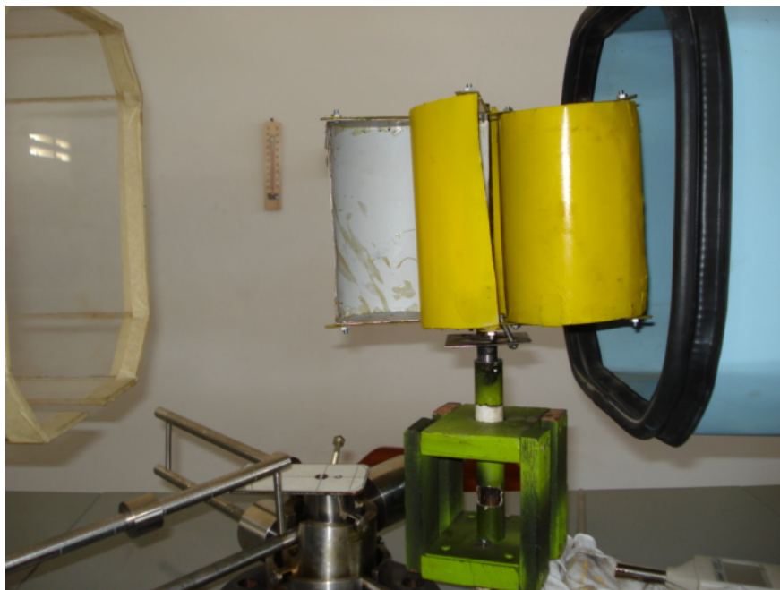
Gambar 4.2. Peletakan Sampel Uji dalam Wind Tunnel
