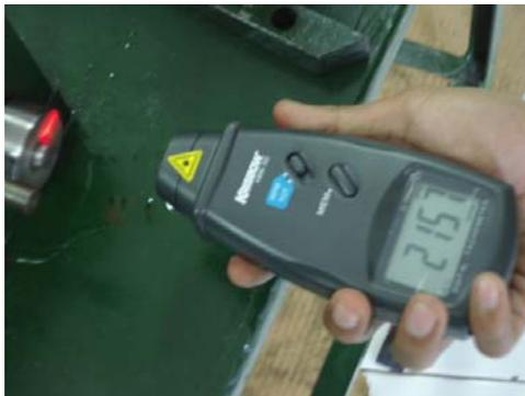
**Gambar 4.5. Tachometer infrared yang digunakan**
