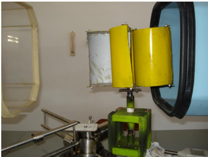
Gambar 4.2. Peletakan Sampel Uji dalam Wind Tunnel
