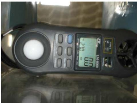
**Gambar 4.6. Anemometer yang digunakan**
