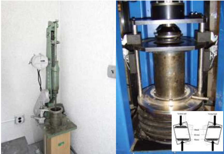
Gambar 2. Alat pematat bahan perkerasan di laboratorium Marshall Hammer (kiri), dan Gyratori Compactor (kanan)
