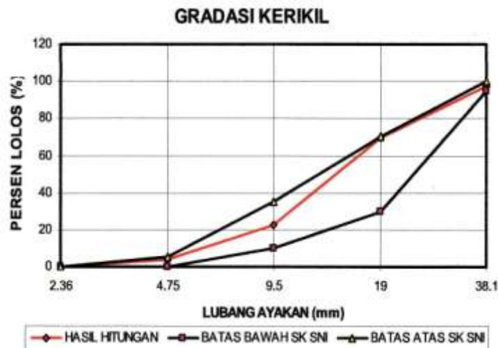
Gambar 3. Grafik Hasil Pengujian Gradasi Kerikil (Departemen Pekerjaan Umum, 1990)
