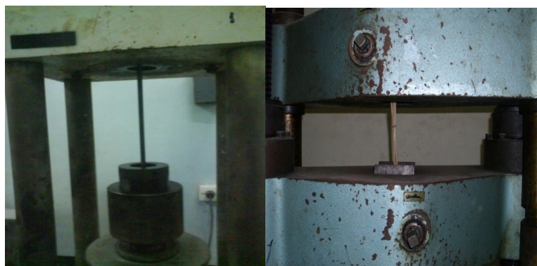
Gambar 2. Uji kuat tarik baja tulangan dan kuat tarik bamboo
