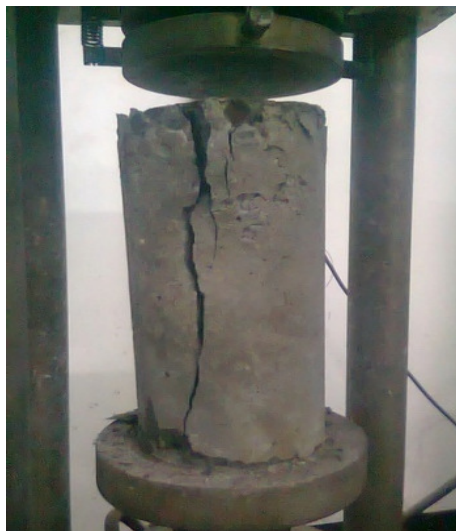
Gambar 1. Uji kuat desak beton
