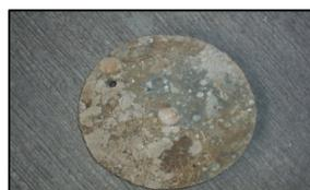
Gambar 10. Benda uji Lempeng beton.
