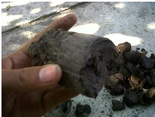
Gambar 5. Sampel sampah kota yang menggumpal dalam *screw pyrolyser*
