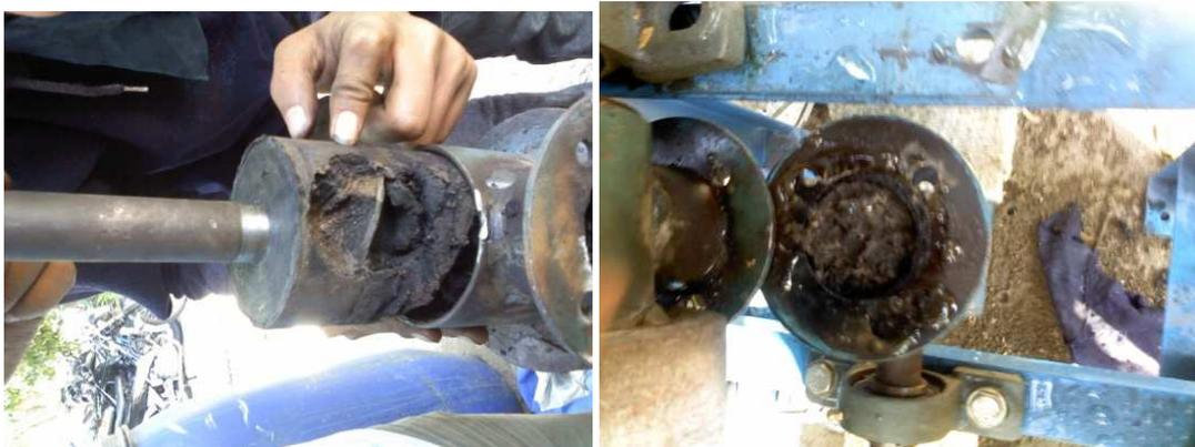
Gambar 4. Sampel sampah kota yang menggumpal dalam *screw pyrolyser*
