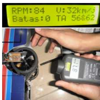
Gambar 4.1 Kondisi pengujian rotary encoder pada roda miniatur bus.
