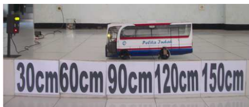
Gambar 4.3 Pengujian Infrared Transmitter dan Receiver Antara Jarak Rambu Peringatan dengan Miniaatur Bus Sejauh 60 centimeter
