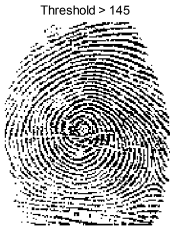
Gambar 6. Tampilan perbaikan citra sidik jari dengan menggunakan proses thinning dengan nilai threshold diatas 145 dimana untuk hasil terbaik dapat dilakukan secara trial and error .
