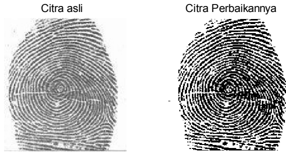
Gambar 5. Tampilan antara citra asli dengan perbaikannya menggunakan metode otomatisasi histogram ( histeq ). Terlihat citra sebelah kanan mampu mereduksi beberapa noise yang ada diantara ridge dan furrow .
