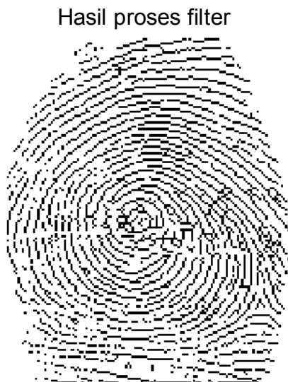
Gambar 6. Tampilan perbaikan citra sidik jari dengan menggunakan proses thinning dengan nilai threshold diatas 145 dimana untuk hasil terbaik dapat dilakukan secara trial and error .
