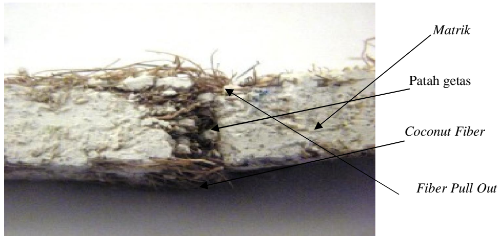
Gambar 8. Penampang patahan kegagalan impact
