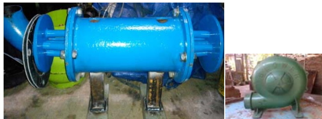
Gambar 4. Gambar heat exchanger yang dirancang beserta blowernya
