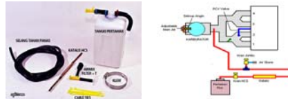
Gambar 2. Perangkat dan skema pemasangan sistem HCS pada mesin mobil
