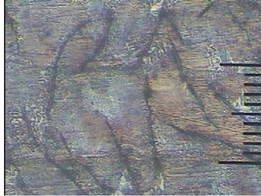
Gambar 4. Struktur mikro spesimen bergrafit serpih yang dipotong dari blok rem metalik.
