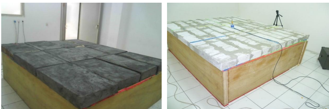
Gambar 3. Benda uji bata konvensional dan bata ringan (dengan plesteran)
