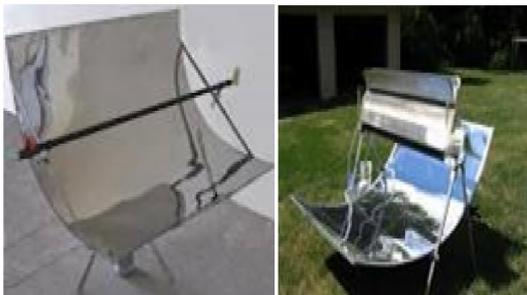
**Gambar 5. Kolektor energi surya sepertiga silinder**
