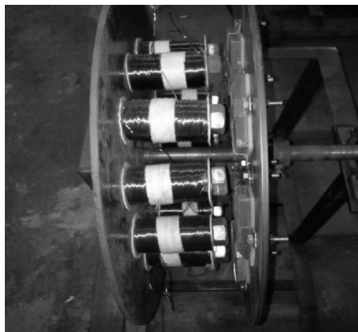
Gambar 3. Kumparan Stator dan Magnet Permanen pada Rotor Generator
