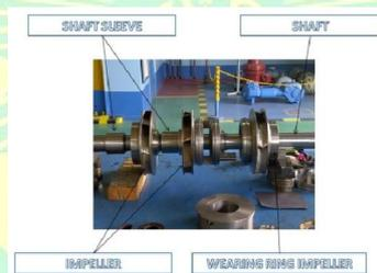
**Gambar 1** Komponen-Komponen Pada *Rotating Element*
