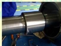
**Gambar 5 Poros Pompa dalam Kondisi Baru**
