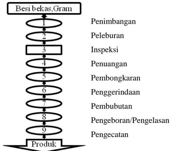
Gambar 3 Peta Proses Pembuatan Besi Cor
