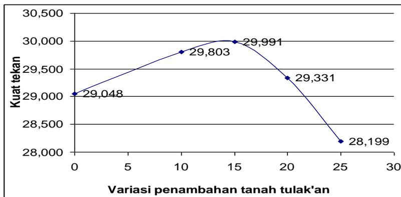
Gambar 2. Grafik Hubungan antara kuat tekan beton dan penambahan Tanah
