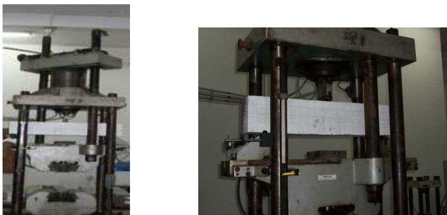
Gambar 6. Proses Pengujian dan Pola Lentur Balok
