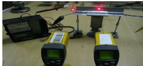
Gambar 7. Rangkaian Pengujian degradasi tahanan isolasi pada kabel
