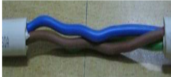
Gambar 2. Kontruksi dari kabel NYM 3x1,5 mm 2 merk B
