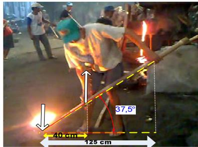
Gambar 2. Gaya yang Terlibat dalam Aktivitas Pengecoran
