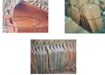
Gambar 1. Cacat Genteng (pecah, patah ujung, tidak padat)
