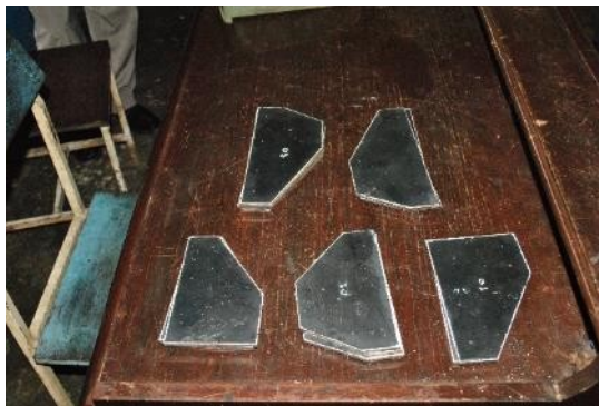
Gambar 18 Reinforce sasis sebelum dilubangi
