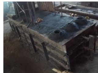
Gambar 9. Pemasangan gate, riser pada pembuatan cetak pasir
