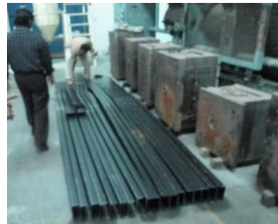
Gambar 16. Pengecekan hasil dan produk sasis long member hasil stamping setelah di uji coba
