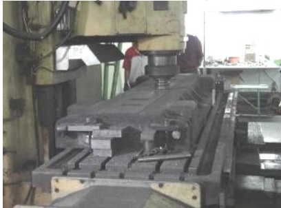
Gambar 12. Proses permesinan plano milling Proses permesinan yang lain yaitu proses slotting pembuatan alur untuk
