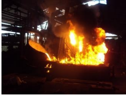
Gambar 10 Pengukuran suhu sebelum di tuang dan proses penuangan logam
