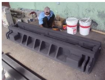
Gambar 8. Pattern yang telah jadi siap untuk dilakukan pelapisan dengan kertas supaya lebih keras
