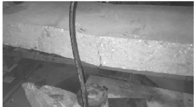
Gambar 3. Pola keruntuhan pada dinding panel
