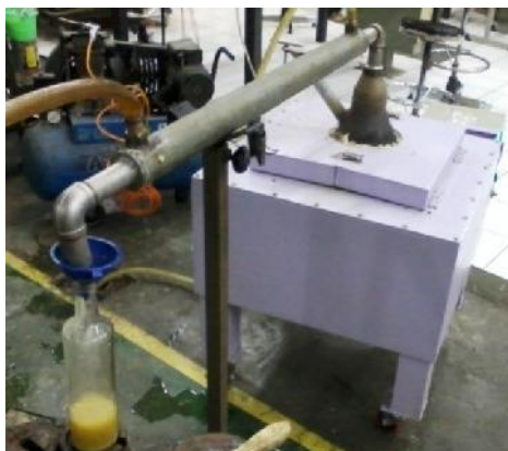
Gambar 1 Konverter sampah plastik menjadi bahan bakar
