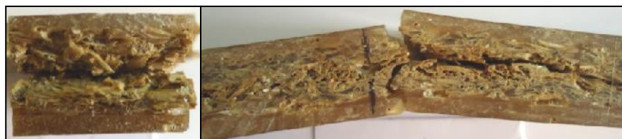
Gambar 4b. Siklus thermal 175°C/125x
