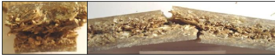
Gambar 4g. Siklus thermal 125°C/25x
