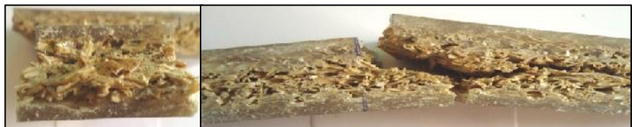
Gambar 4i. Siklus thermal 75°C/75x
