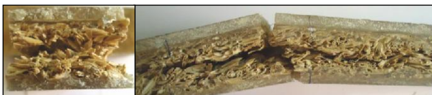
Gambar 4d. Siklus thermal 175°C/25x
