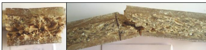
Gambar 4c.. Siklus thermal 175°C/75x
