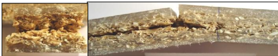
Gambar 4j. Siklus thermal 75°C/25x
