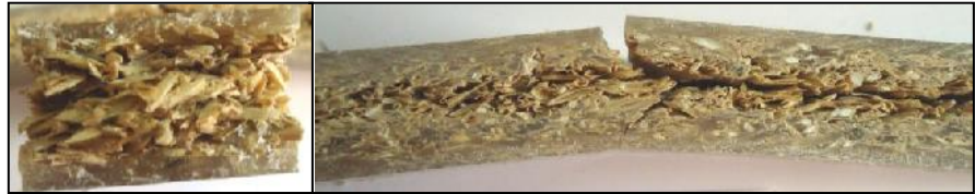
Gambar 4h. Siklus thermal 75°C/125x
