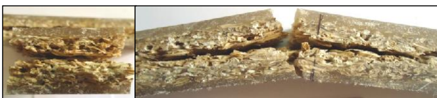
Gambar 4e. Siklus thermal 125°C/125x
