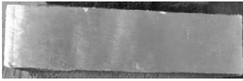
Gambar 10. Penampang potong pada sampel uji Y-blok dengan deoksidasi 0,3 % Al
