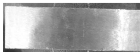
Gambar 9. Penampang potong pada sampel uji Y-blok dengan deoksidasi 0,2 % Al
