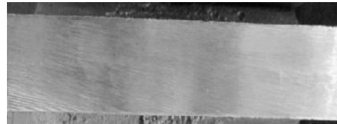
Gambar 11. Penampang potong pada sampel uji Y-blok dengan deoksidasi 0,4 % Al
