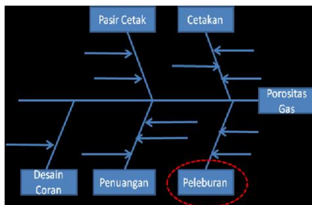
Gambar 3. Skema fish bone porositas gas
