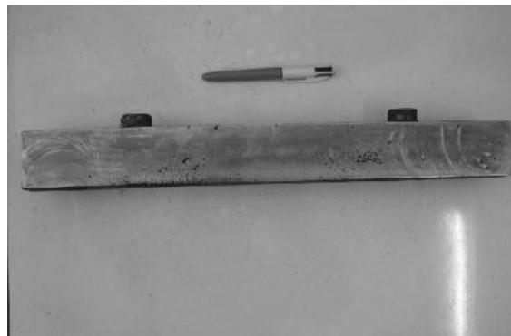
Gambar 14. Penampang potong pada Prototip “replaceable lip” dengan deoksidasi 0,3 % Al
