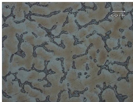
Gambar 18. Penampang potong pada sampel uji Y-blok dengan deoksidasi 0,2 % Al, Austenite 71%, Karbida krom 29%
