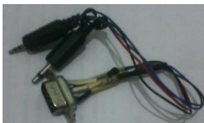
Gambar 8 Bentuk fisis pengawatan dari port modulator pada TNC ke port audio pada radio transmitter
