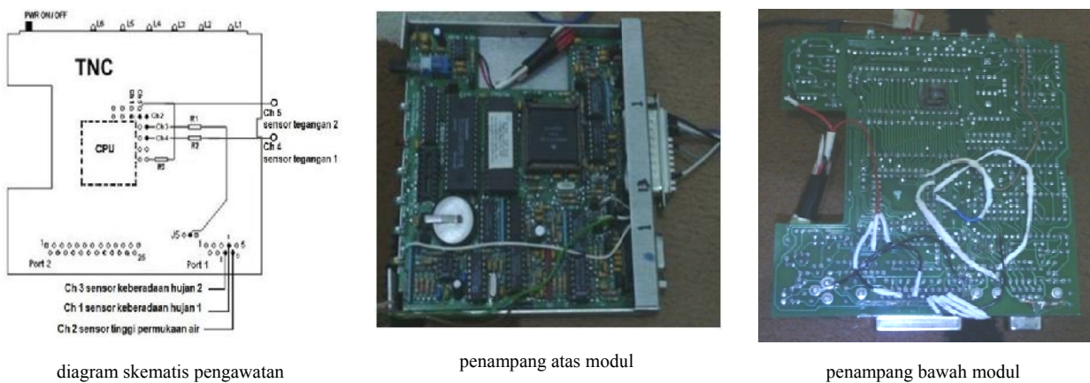
Gambar 7Hasil modifikasi terhadap TNC guna perolehan kanal ADC masukan tambahan untuk sensor
