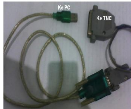
bentuk fisis pengawatan dari port TNC ke port pada PC
