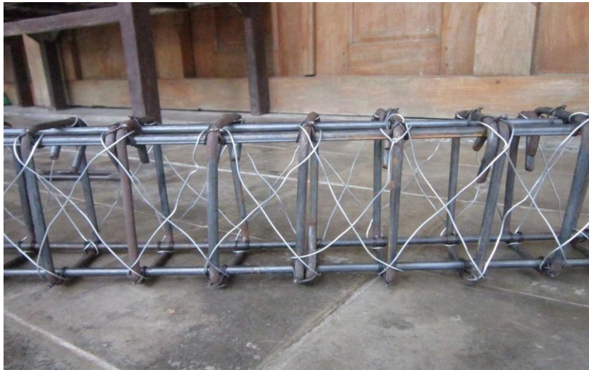
Gambar 2. Bentuk penulangan balok dengan perkuatan kawat galvanis menyilang
