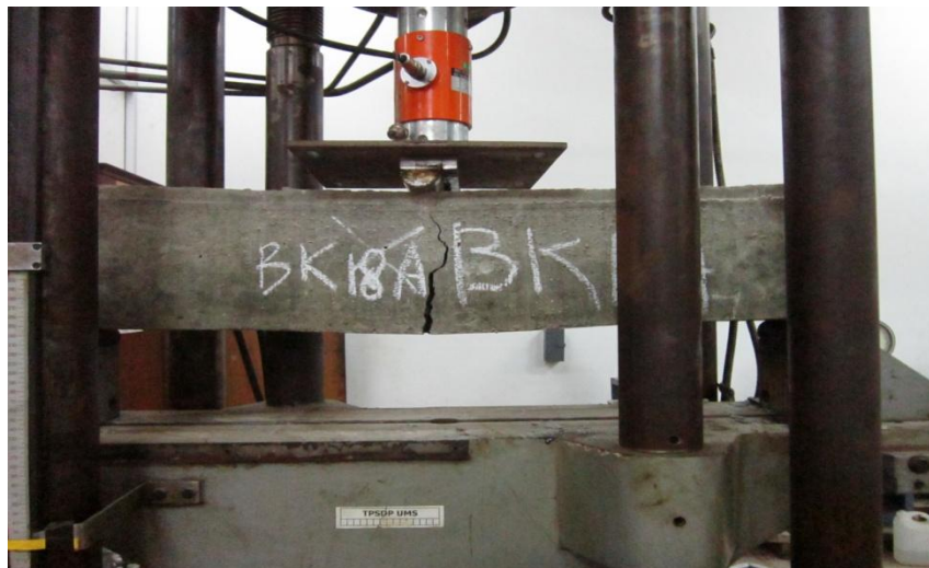
Gambar 1. Pengujian kuat lentur balok
