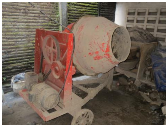
Gambar IV-17 Molen pengaduk beton
