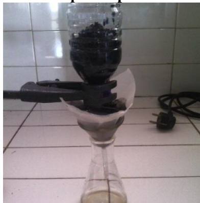
Gambar 3. Kolom Penyaringan Asap Cair dengan Arang Aktif
