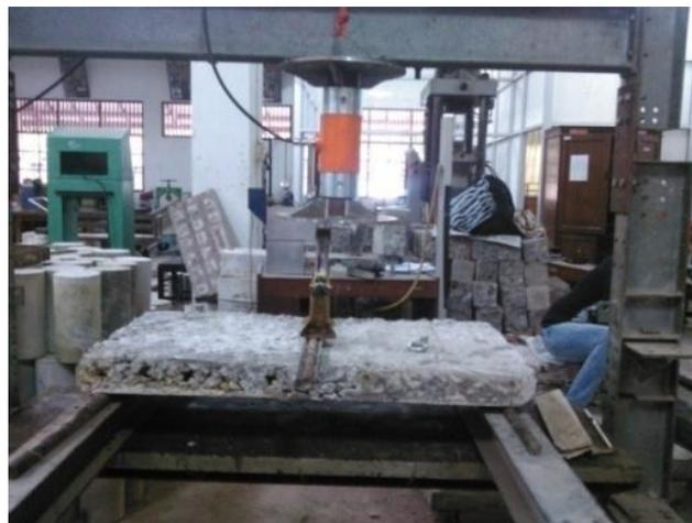
**Gambar 3.** Pengujian kuat lentur pelat beton
