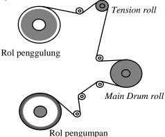
Gambar 3. Kontruksi Rol Mesin Metallizing
