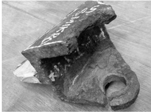
Gambar 1. Scaling pada produk Hanger
