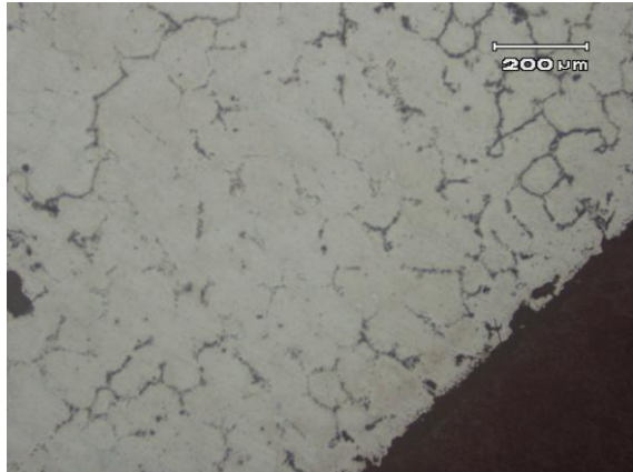
Gambar 13. Struktur mikro SCH 22 setelah dipanaskan 1150°C, tanpa modifikasi Mo
