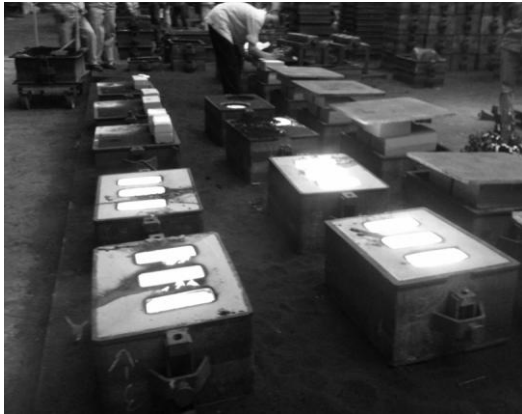
Gambar 5. Cetakan yang sudah dicor
