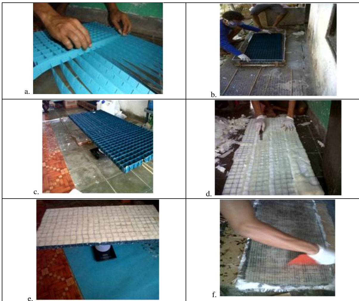
Gambar 2 Proses pembuatan komposit sandwich
