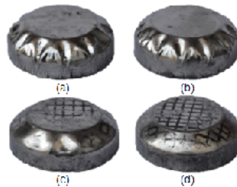
Gambar 14. Cup hasil eksperimen material plat seng dan aluminium.
