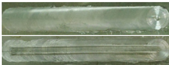
Gambar 4. Hasil las dengan depth plunge 0.9,1.7.,2,9 mm
